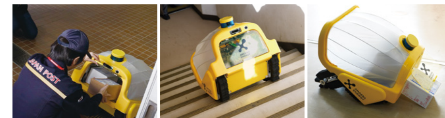
■図2 置き配実験の様子。郵便局員が荷物を載せると、ソフトロボットが目的の部屋まで運ぶ(左、中)。玄関前に着くと機体を傾けて荷物を滑らせるように下ろすので、衝撃も少ない(右)。6キログラムまで積載できる。
