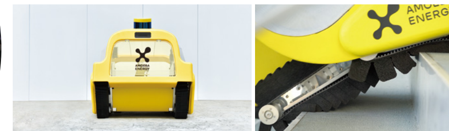
■図1 Amoeba GO-1(左)と柔らかいスポンジ状のクローラー(右)
