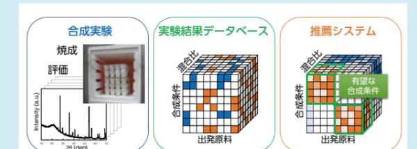
推薦システムの概念図。整備した実験結果データベースに基づき、まだ試していない合成条件から有望な条件を推薦する。オレンジ色は、合成条件の点数およびスコアが高いことを表している。
