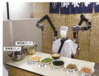
■ 図6 うどん板前ロボット。具材の要不要や増減など客の希望を聞きながら、ロボットアームと5本指ロボット手を駆使して最適なメニューを作る。
