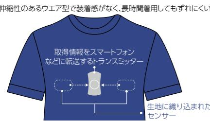
■図1 スポーツウェア型センサー。汗に強く、軽いセンサーを搭載し、運動中でも違和感なく心拍数や心電波形を測定できる。
