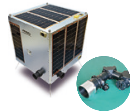
■図1 小形衛星を用いたリモートセンシングビジネス実証機であるほどよし1号機。一辺約50センチメートルの立方体で、重さは60キログラム。
