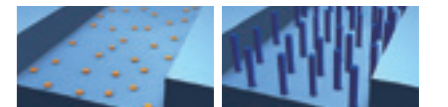
■図1 金を利用したナノワイヤの作成方法。ナノワイヤを成長させたい基板上に金の微粒子を付着させ、加熱する(左)。金が触媒の役割を果たし、金が付着している場所だけにナノワイヤが成長していく(右)。
