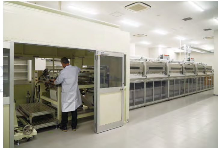
■図5 ナノカーボン複合RO膜の生産ライン。信州大学国際科学イノベーションセンター内に設置されている。
