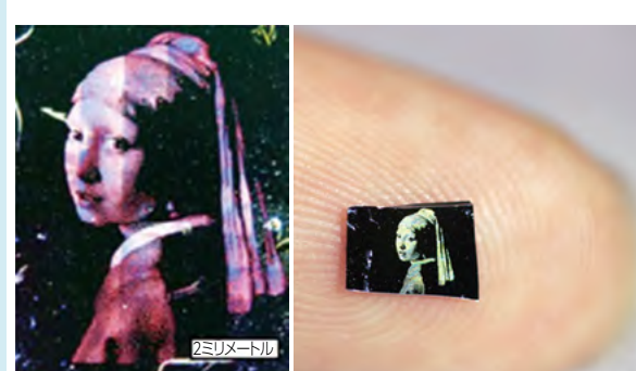
インクを使わずに印刷された絵画。光を照射した部分に多層構造が形成され、発色により絵を描くことができる(左)。光の当たり方によって色が変わって見える(右)。
