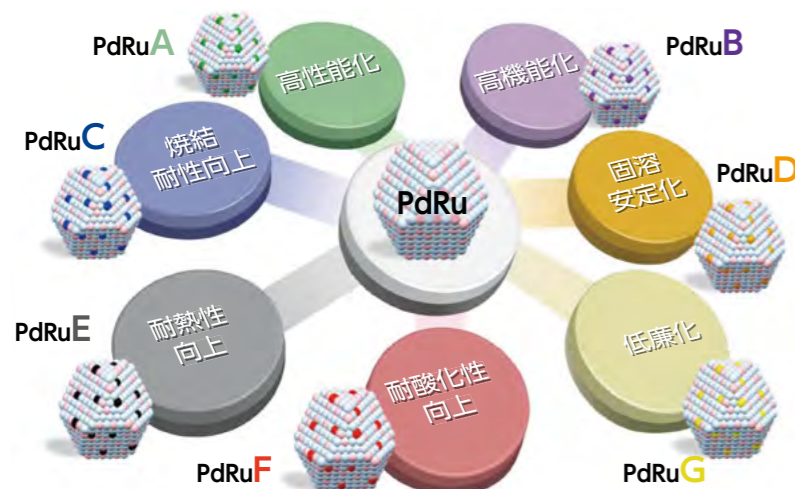
■図5 パラジウムとルテニウムの合金ナノ粒子に、第3の元素を追加すれば、新たな性能が加わり用途開発につながる可能性を秘める。
