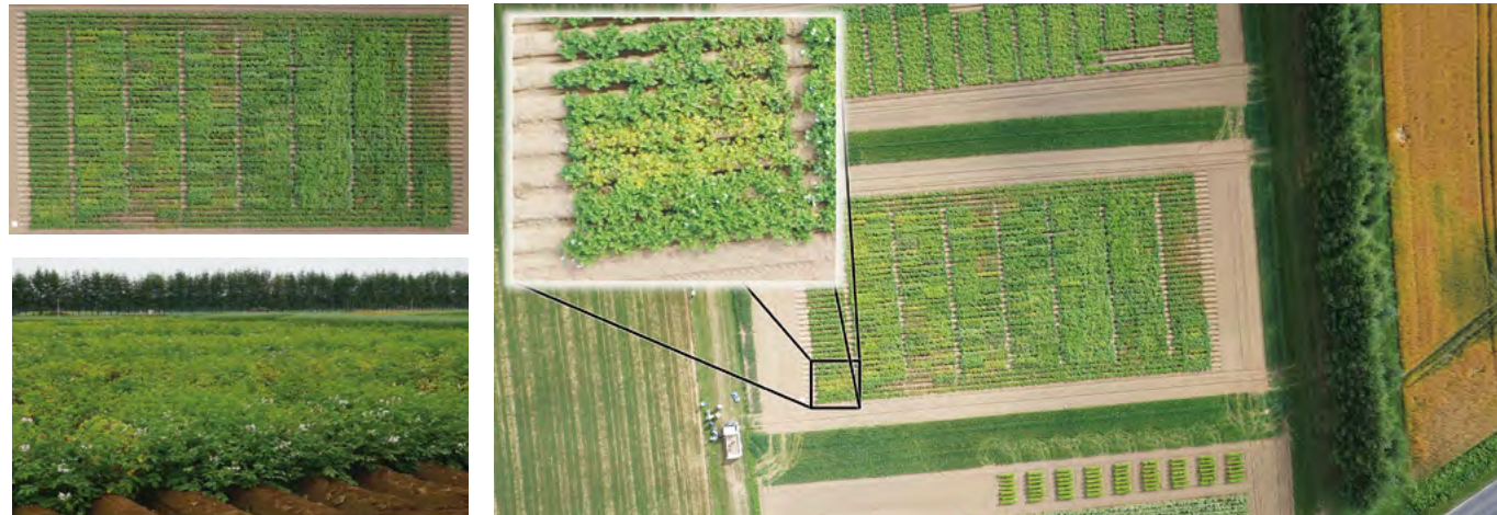
■図1 地面では作物がそろって見えるが(左下)、100メートル上空から見下ろすとばらつきが明確にわかる(左上)。1画素が地上の3センチメートルに相当し、作物個体が識別できるほど高精細に撮影できる(右)。
