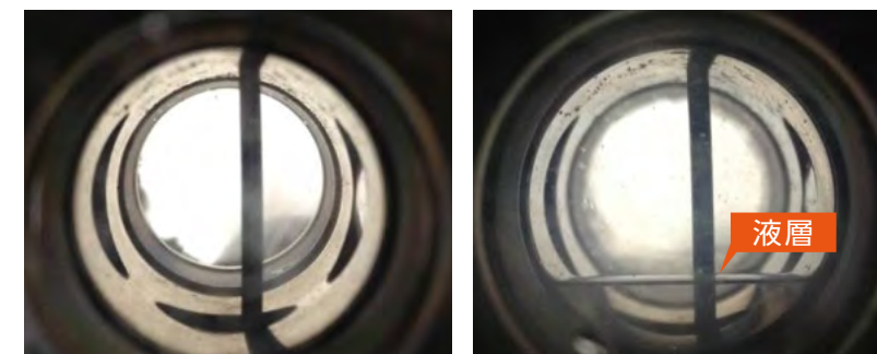
■図6 高圧のCO 2 を冷却すると液化するため、水素をガスとして、CO 2 を液体として分離できる。冷却前(左)では均一のガスだが、冷却すると(右)CO 2 が液化して容易に取り除くことができる。
