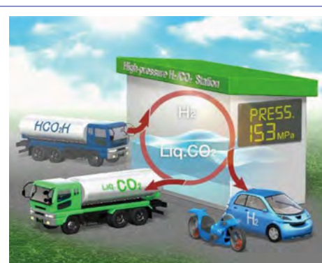
ギ酸による水素ステーションの想像図。水素を高圧化するためのコンプレッサーなどが不要で、比較的シンプルな設備で高圧水素を製造できるので、低コストの水素ステーションが実現できると期待されている。 ©Republished with permission of Royal Society of Chemistry, from the back cover of "Sustainable Energy & Fuels", Issue 8, 2018; permission conveyed through Copyright Clearance Center, Inc.
