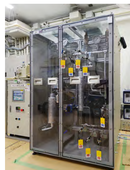
■図4 密閉容器中のギ酸脱水素化反応。高性能の触媒を使用することで、より高圧の水素を発生させることが可能になる。実際には水素と同量のCO 2 も発生する。
