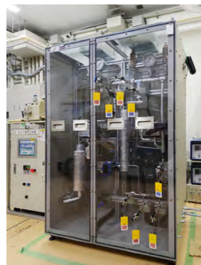
■図4 密閉容器中のギ酸脱水酸化反応。高性能の触媒を使用することで、より高圧の水素を発生させることが可能になる。実際には水素と同量のCO 2 も発生する。
