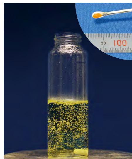
■図3 50度以上に加熱したギ酸に触媒(右上)を加えると、勢いよく水素ガスが発生する。
