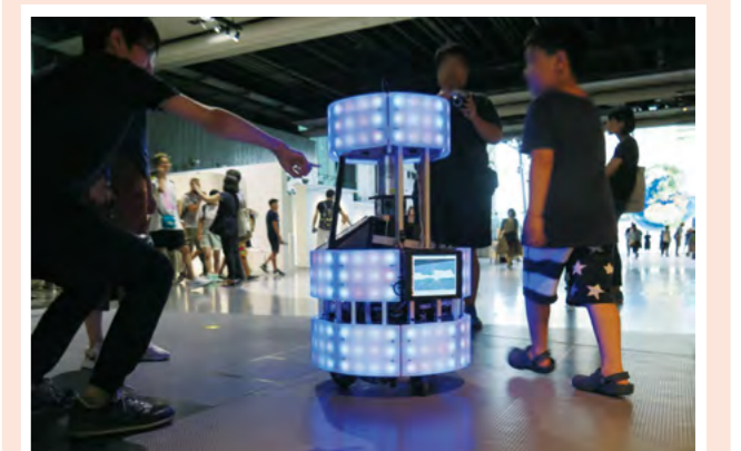
ロボットが周囲の人の動きから通路を判断し、避けながら目的地へ向かっている様子。
