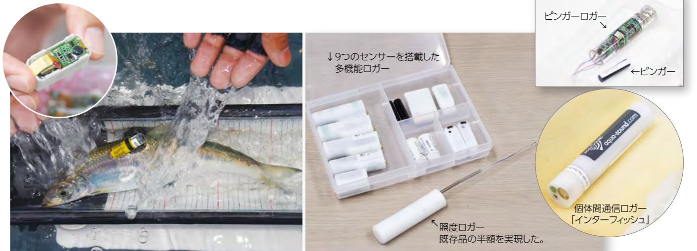
■図2 既存品の3分の1の価格帯まで抑えた小型の水温・深度ロガー。■図3 開発したロガーの数々。9つのセンサーを搭載した多機能ロガーは環境情報と生体情報を同時に取得できる。ピンガー(超音波発信機)とピンガー・ロガー、インターフィッシュは、たくさんのピンガーから届く受信機の情報一度に受信できる原理を採用し、受信率が飛躍的に高まった。既存品では全ての情報を同時受信できなかった。
