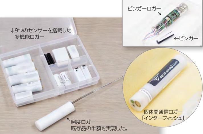
■図3 開発したロガーの数々。9つのセンサーを搭載した多機能ロガーは環境情報と生体情報を同時に取得できる。ピンガー(超音波発信機)とピンガーロガー、インターフィッシュは、たくさんのピンガーから届く受信機の情報一度に受信できる原理を採用し、受信率が飛躍的に高まった。既存品では全ての情報を同時受信できなかった。
