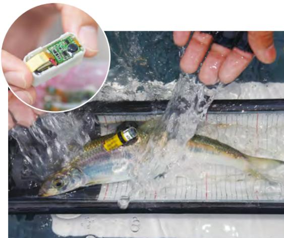
■図2 既存品の3分の1の価格帯まで抑えた小型の水温・深度ロガー。これまでに1000機を作製し、実証試験に活用している。
