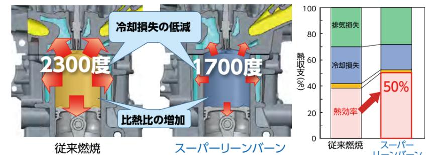
図2 スーパーリーンバーンによる低温燃焼の実現により、エネルギー損失を抑え、熱効率を向上できる。
