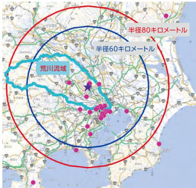
■図3 MP-PAWRが設置されている埼玉大(図中の★)を中心とした半径80キロメートルが最大観測範囲となる。半径60キロメートルではより高層の雲も観測可能。観測範囲内には荒川流域やオリンピック・パラリンピックの競技場(図中の●)の多くが含まれる。
