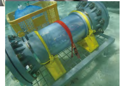
装置を筒状の容器に入れて、電源や試薬とともにサンゴ礁底に設置して連続観測する。
