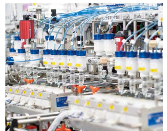
■図2 わずかに含まれる炭素14を高精度に分析するために開発した自動前処理装置。加速器質量分析装置で測定するためには試料に含まれる炭素をグラファイトという状態にする必要がある。この工程を自動化したことで従来は2日間かかっていた作業を半日に短縮できるようになった。
