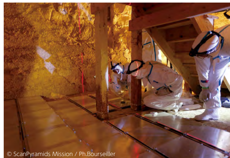
ピラミッド内部をミュオンで透視できることを実証するため、まずはクフ王の父でもあるスネフェル王の屈折ピラミッドに原子核乾板を設置した。原子核乾板はアルミ板で保護の上、固定されている。
