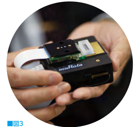
■図3 村田製作所が開発した手のひらサイズの測定装置。ノートパソコンやスマートフォンと接続すれば測定可能で、空港の検疫や鳥小屋などどんな場所でも使える。
