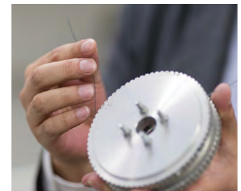
繊維状のセラミックスをコーティングし、束にして焼き固める。右手の細い糸が長繊維強化自己治癒セラミックス。
