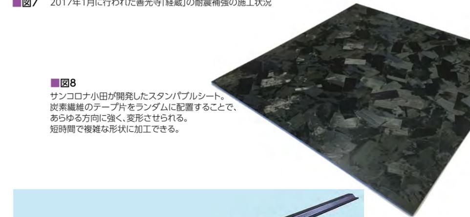
■図8 サンコロナ小田が開発したスタンパブルシート。炭素繊維のテープ片をランダムに配置することで、あらゆる方向に強く、変形させられる。短時間で複雑な形状に加工できる。
