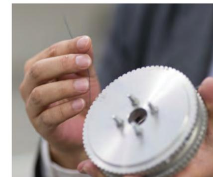
繊維状のセラミックスをコーティングし、束にして焼き固める。右手の細い糸が長繊維強化自己治癒セラミックス。
