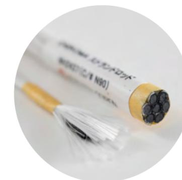
図3 芯材となる炭素繊維の束の周りをガラス繊維の組ひもで覆い、炭素繊維の束にゆるやかなより(ストランドロッド)を加えて強度を向上させた。
