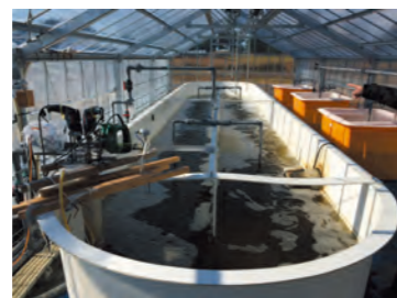
姫路市の下水処理施設「大的析水苑」に完成した培養施設。(左) レースウェイ型水槽(右) プール型水槽。
