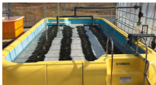
姫路市の下水処理施設「大的析水苑」に完成した培養施設。(左) レースウェイ型水槽(右) プール型水槽。
