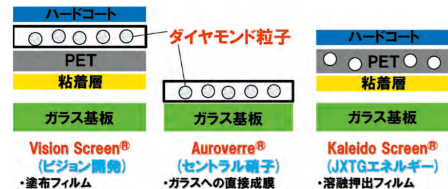
図2 各社の製品の構造の違い。左からビジョン開発社、セントラル硝子社、JXTGエネルギー社のもの。JXTGエネルギー社はダイヤモンド粒子の代わりにジルコニア粒子を使用している。
