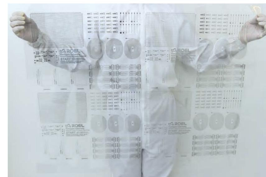
上：銀ナノインクを用いてPET樹脂製のフィルムに大面積の電子回路を印刷した試作品。部品ごとに切り分けて使うことができる。
