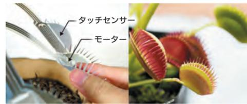
ソフトロボットにより植物のやわらかさと動きを再現した例。タッチセンサーとモーターの一体化によってハエトリソウを模したソフトロボットを作製した。
