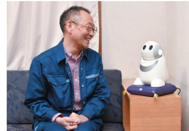
右側が高齢者に声かけをするロボット。座布団の部分にルーターになっており、インターネットに接続されている。高齢者を支える周囲の人たちが入力した、個々の高齢者にとって必要な情報に基づき、ロボットが必要な時に声をかけて行動を促す。
