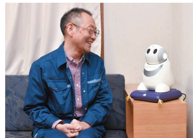
右側が高齢者に声かけをするロボット。座布団の部分がルーターになっており、インターネットに接続されている。高齢者を支える周囲の人たちが入力した、個々の高齢者にとって必要な情報に基づき、ロボットが必要な時に声をかけて行動を促す。
