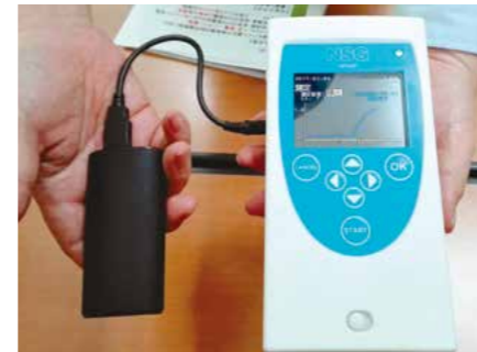
モバイル遺伝子検査機(試作機)。 高さ200mm×幅100mm×厚み50mm、重量約500g。
