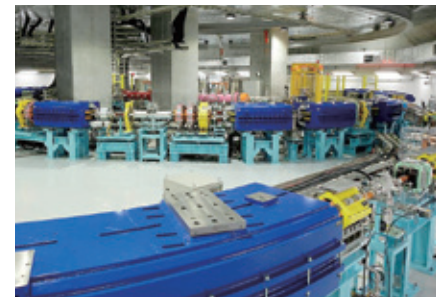
炭素イオンを超高速に加速するため、直径20mもの大型の円形加速器が、この施設の半分以上を占めている。
