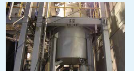
セルロース資源からエタノールを生産するパイロットスケールのバイオリクター(写真提供:Bio-energy)
