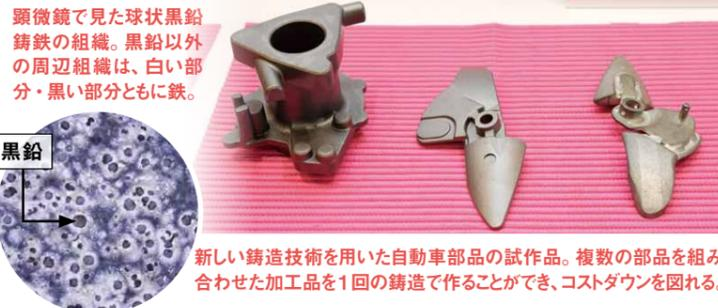
新しい鋳造技術を用いた自動車部品の試作品。複数の部品を組み合わせた加工品を1回の鋳造で作ることができ、コストダウンを図れる。
