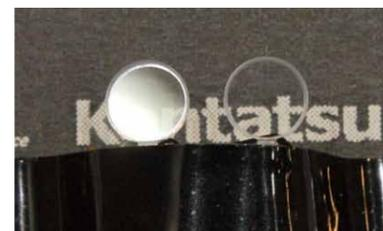
表面にナノサイズの構造体を持つ試作品レンズ(右)。左のレンズはナノ構造体がないので反射して白く見えている。
