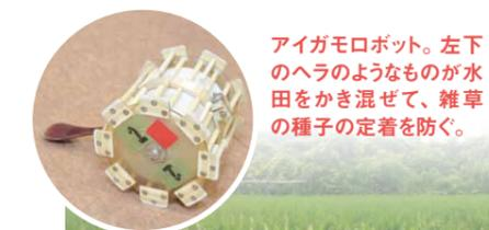
アイガモロボット。左下のヘラのようなものが水田をかき混ぜて、雑草の種子の定着を防ぐ。
