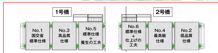
（上）2014年7月に完成したロハスの橋（日本大学工学部キャンパス）。（下）タイプの異なる6種類の鉄筋コンクリート製の床版を野外に作製し、1年間にわたり実測データを収集している。
