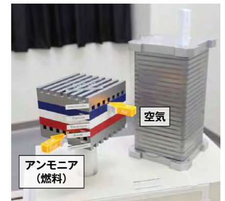
燃料電池のセル(左)とスタック(右)の模型。燃料極(赤)、電解質(白)、空気極(青)の3層を挟むセパレータ(銀)は、燃料と空気を極全体に供給する通路の役割も果たしている。これを複数重ねたものがスタック。
