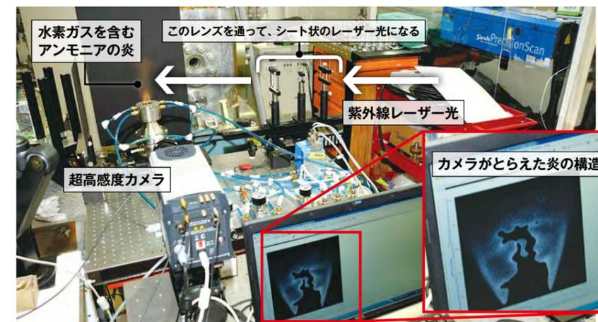
紫外線レーザーをアンモニア火炎に当て、瞬間の構造を超高感度カメラで撮影する装置。手前の画像の白く光った明るい部分にはOHという化学種が豊富にある。黒い部分はまだ燃焼していないガス。黒い部分と白い部分の境界で発熱している。
