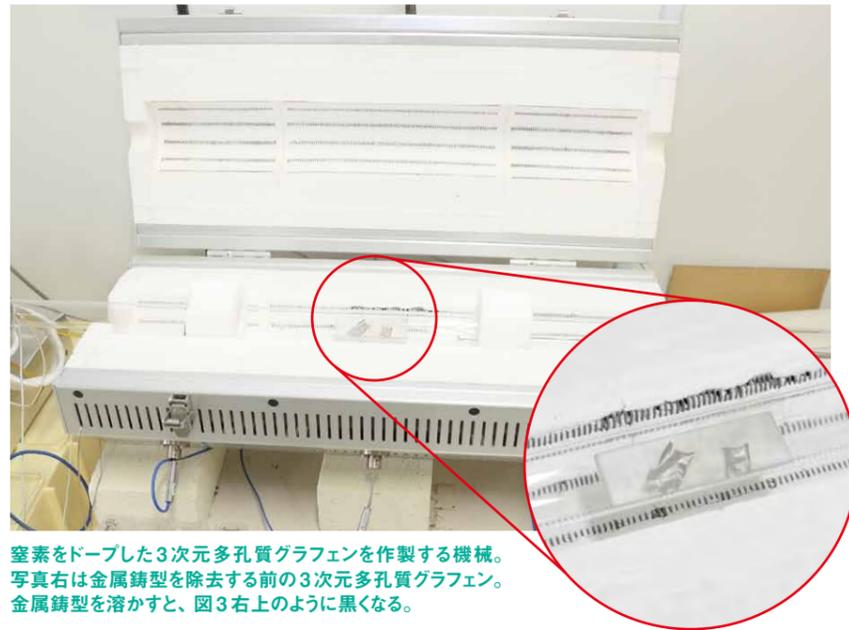
窒素をドーピングした3次元多孔質グラフェンを作製する機械。写真右は金属鑄型を除去する前の3次元多孔質グラフェン。金属鑄型を溶かすと、図3右上のように黒くなる。
