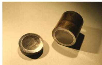
中心の黒い部分が、鉄系高温超伝導体。周囲は複合金属リング。
