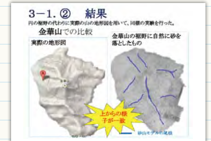
砂山シミュレーションの結果例(発表会資料より)。実際の地形図模型の上に砂をかけ、微振動を与えると、実際の尾根と同様の尾根が再現できた。
