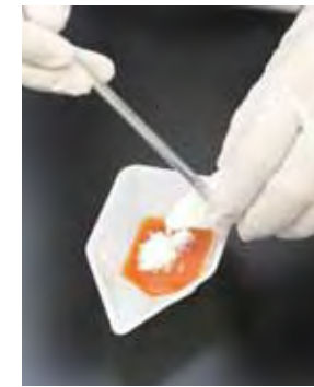
①すりつぶした農産物に脱水剤を混ぜる。
