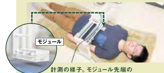
計測の様子。モジュール先端のセンサーを心臓の位置に合わせる。
