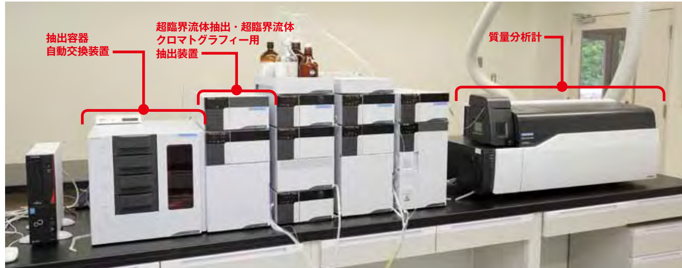
開発された質量分析システムの全体。島津製作所ですでに製品化されている。
