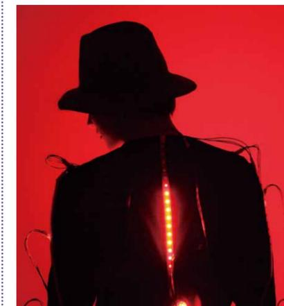
m plus plusが開発したLEDを配置した衣装。音楽や体の動きに合わせて精密に制御できる。
