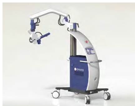
空気圧駆動の内視鏡ホルダロボット。内視鏡を持つ手が空くので、効率的に手術できる。
