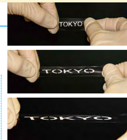
導電性インクで文字をプリント。3倍以上伸びても導電性は保たれる。
