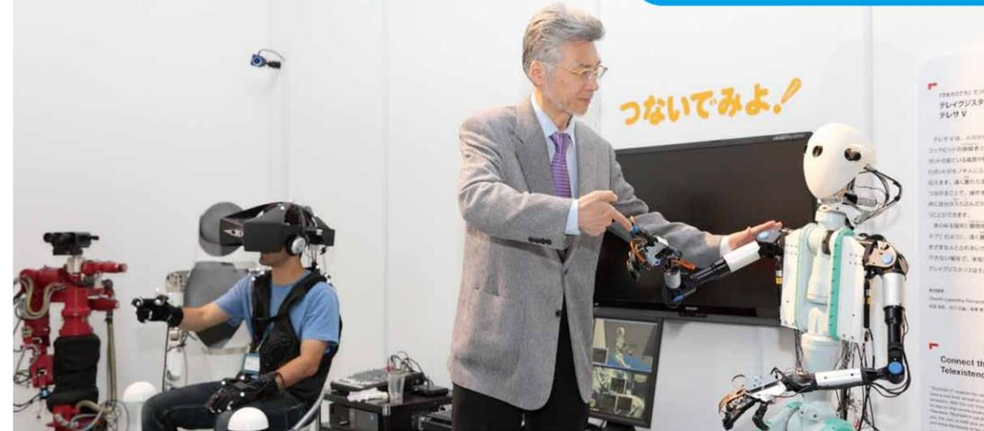
トレイグジスタンスを体感する装置。画面奥の人は、自分が手前のロボットの中に入り込んだように感じる。自分の動きに連動して動くロボットのカメラやマイクからの視聴覚情報を、頭部搭載型ディスプレイ(HMD)やヘッドフォンで得ると同時に、ロボットの指がとらえた圧覚や振動をグローブで感じることで、トレイグジスタンス感覚を得ている。
