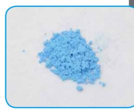
◀ CO だけを選択的に吸着する PCP。粉末では使いにくい板状にするなどの加工を施してから試験機に装着する。青い色は、使われている銅イオンに由来する。
