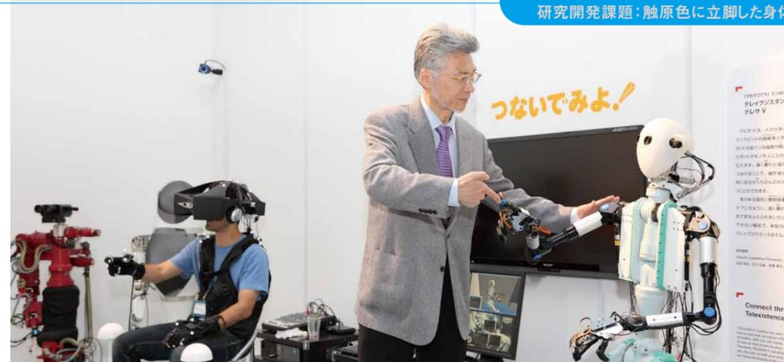
トレイグジスタンスを体感する装置。画面奥の人は、自分が手前のロボットの中に入り込んだように感じる。自分の動きに連動して動くロボットのカメラやマイクからの視聴覚情報を、頭部搭載型ディスプレイ(HMD)やヘッドフォンで得ると同時に、ロボットの指がとらえた圧覚や振動をグローブで感じることで、トレイグジスタンス感覚を得ている。
