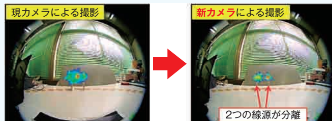
同じ条件で取得したガンマ線画像。新しいカメラでは、10度離して置いた2つの放射線源を別のものとしてとらえられ、分解能が高い。
