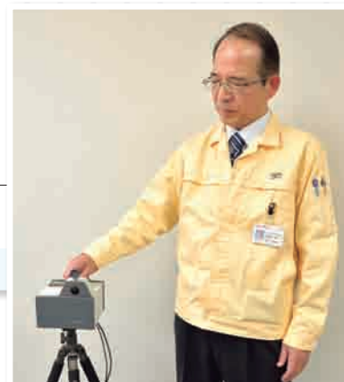
開発したコンプトンカメラ。現場で使いやすい小型・軽量化を実現している。
