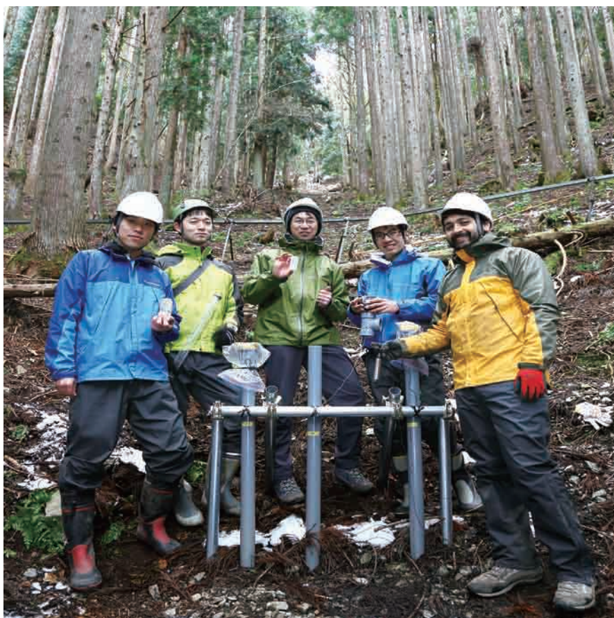
葛川流域（滋賀県大津市、p.5左上）の調査地点で。調査ボーリングの跡の孔に塩ビ管を通し、山体地下水についてさまざまな調査をする。塩ビ管の地中側の先端部側面には穴があけられており、地下水位が上がると塩ビ管内の水位も連動して上がる。地下水をサンプリングして水質を調べるほか、複数のボーリング孔や雨水のイオンの構成比などを比較することで、雨水や山体地下水の動きを解析できる。中央が小杉さん。
