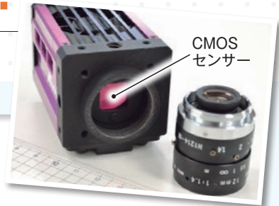
小型のビデオカメラを取り付けた、高感度タイプのCMOSセンサー。レンズをはずすと、すぐ奥に受光部が見える。
