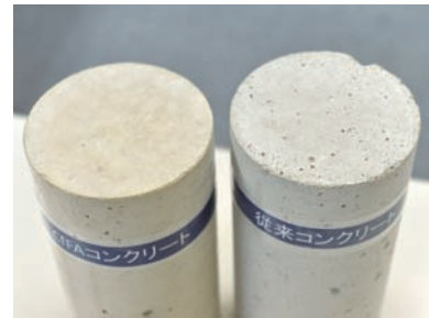
左側がCfFAを混ぜたコンクリート。従来のコンクリート(右)に比べて、表面が滑らかで美しくなる。
