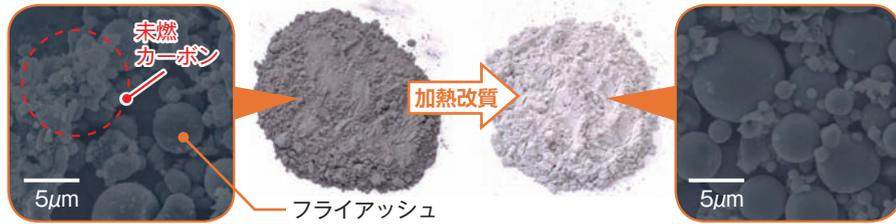
処理前のフライアッシュは、未燃カーボンが多く含まれているため色が黒っぽい。CfFAをつくるには、熱処理の温度管理が重要だ。ボゾラン反応は1,000℃以上で熱すると活性を失い、650℃以下だと未燃カーボンを1%以下にすることができない。発電設備や石炭の種類にばらつきがあるため、そのさじ加減が難しい。そのため、石巻工場で使う複数種類の石炭にそれぞれ適合したCfFAの製造プロセスを開発している。
