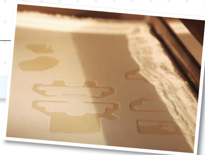
3Dプリンターの内部。「手術支援ガイド」は、材料の粉をレーザーで少しずつ焼き固めて作る。
