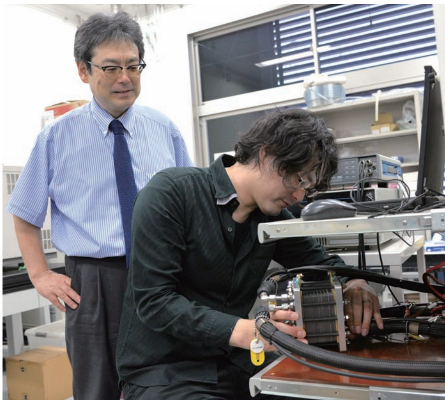
燃料電池評価システムに燃料電池を接続する九州大学カーボンニュートラル・エネルギー国際研究所(I 2 CNER)/大学院工学研究院助教の松本崇弘さん(右)と見守る小江さん。下は燃料電池。
