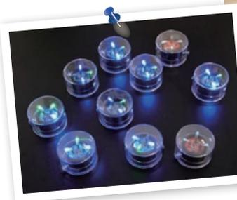
ミッション7「ホテルとシンク口せよ」。明滅する光が同期するホテルの集団発光が、電子回路でも起きることを「LEDホテル」（写真）で実験。
